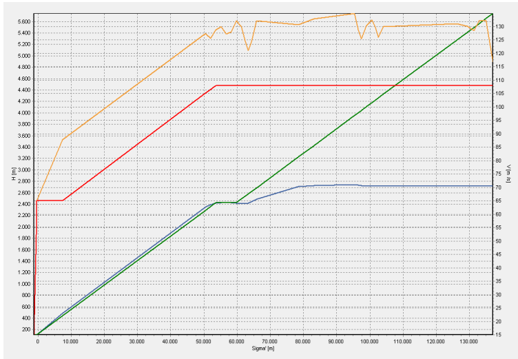
Abbildung 4-9: Geschwindigkeits- sowie Höhenprofile aus Radardaten und nachgebildetes AzB Flugprofil für einen Anflug der Luftfahrzeugklasse S 5.1-L mit Radarführungshöhe detektiert als Zwischenanflugsegment (für Grundlagenermittlung blaues und grünes Höhenprofil verwendet, für endgültige Berechnung blaues Höhenprofil verwendet)
